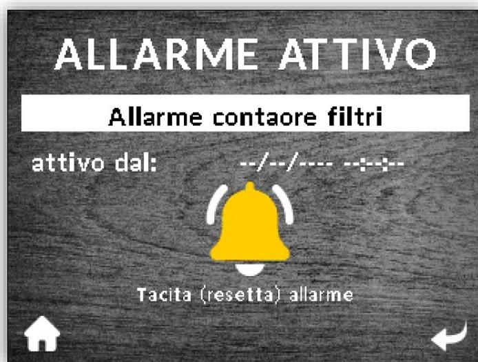
Figura 11 - Schermata di visualizzazione dell'allarme attivo
