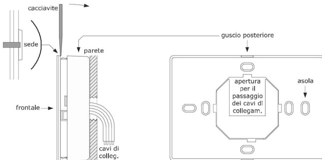
Figura 4 - Dimensioni per fissaggio controllo remoto COLOR-TOUCH
