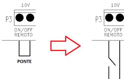
Figura 5 - Collegamento di dispositivo esterno per l'on-off remoto
