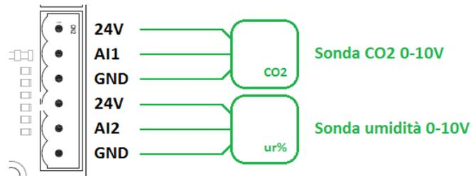
Figura 6 – Collegamento sonde umidità e qualità aria 0-10V
