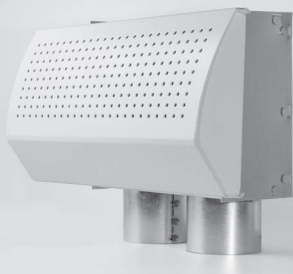
ROZ-ZB-2P ROZ-ZB-20 KIT MANDATA O RIPRESA A 90° Formato da una normale bocchetta più plenum per rimando a 90° e attacco per 2 tubi da 75 mm
