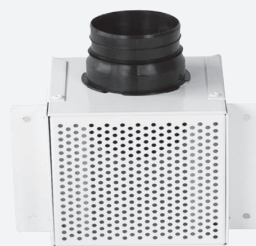
ROZ-EGFC GRIGLIA FORELLINATA Completa di plenum per installazione a scomparsa in pareti di cartongesso. La griglia è disponibile con 1, 2 o 3 attacchi. Dimensioni 120x120 mm, 300x120 mm e 400x120 mm.
