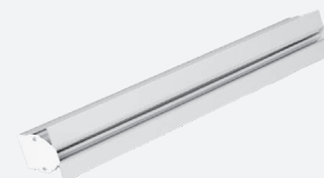
ROZ-EDLSV DIFFUSORI LINEARI A scomparsa per impianti vmc con una feritoia da 30 mm con profilo aerodinamico in allumi- nio e deflettori regolabili, per un ottimale controllo del lancio dell'aria. Dimensioni realizzabili: lunghezza 500 mm; - lunghezza 800 mm.
