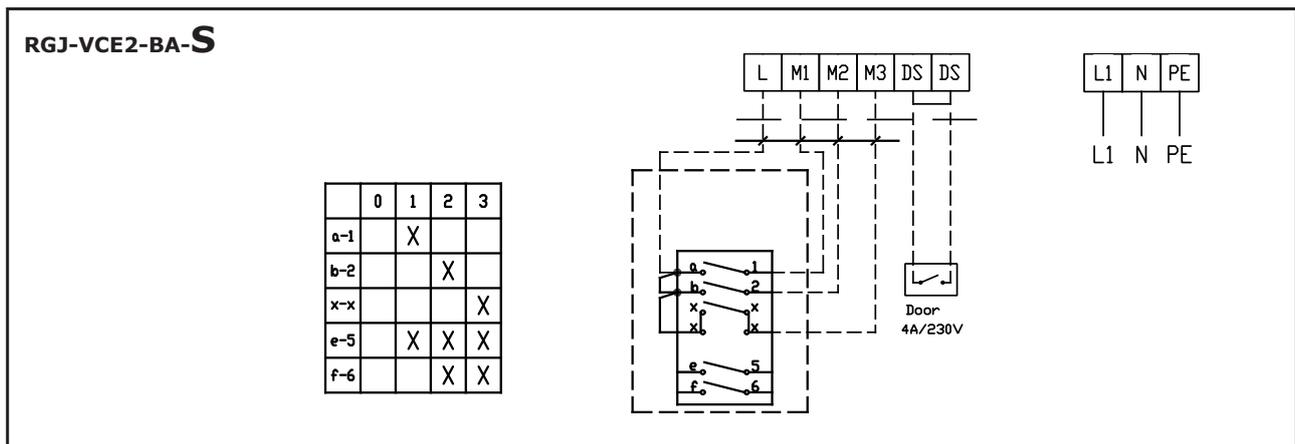
\*Un cavo con una sezione trasversale minima di  $6 \times 0,5 \text{ mm}^2$  è raccomandato per il collegamento del pannello di comando.
